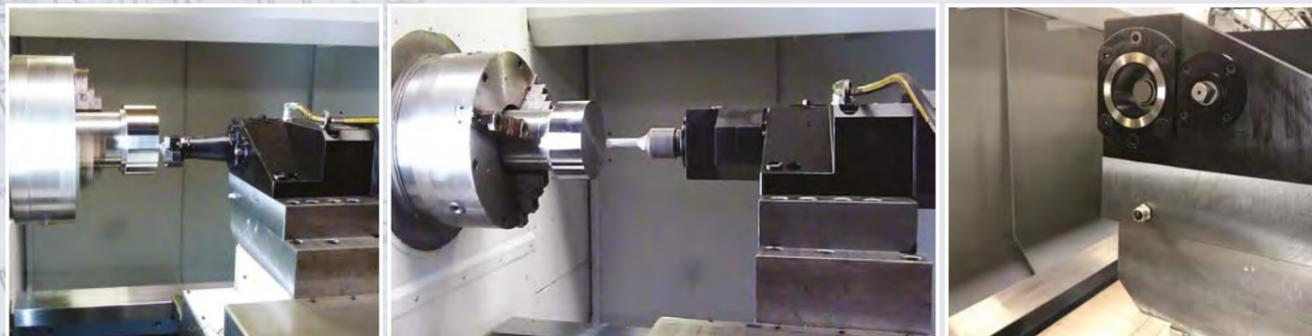
WTO-Werkzeugsystem zum Drehen, Fräsen und Bohren
