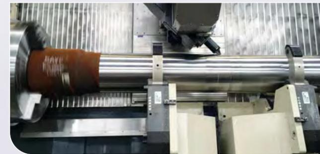
Hydraulische Lünetten mit unabhängiger Steuerung
