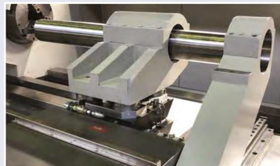
Bohrstangenhalter montiert auf Nullpunkt- Spannsystem
