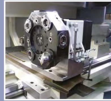
Revolverkopf mit Capto Werkzeugscheibe
