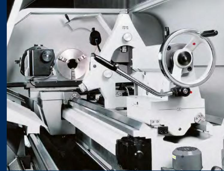
Die spezielle 3-Prismen-Konstruktion des Bettes mit tiefgehärteten und geschliffenen Führungen sorgt für Steifigkeit und Stabilität. Das Bett wird als Monoblock gegossen.
