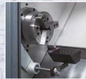
FTM 165 mit Sternrevolverkopf, Gegenspindel und das Teileentnahmesystem
