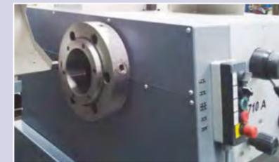
Hintere Spindelnahe mit 140mm Spindelbohrung
