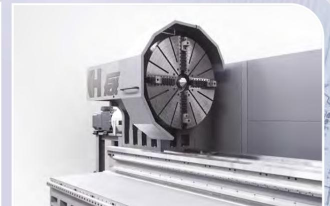
▶ Ein Spindelstock mit einer Spindel mit einem Durchgang von 185 mm, ausgelegt für die Schwerzerspannung. Durch den Einsatz eines Planetengetriebes ist ein Drehmoment von bis zu 100.000 Nm möglich
