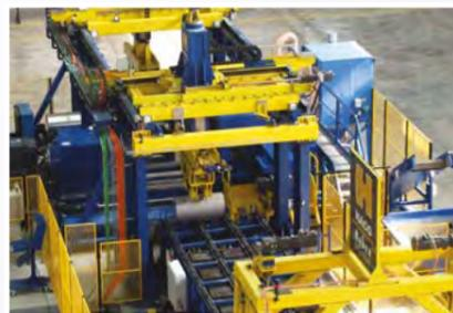
Eine Drehmaschine zur Bearbeitung von elektrischen Isolatoren. Die Papier-Epoxid-Masse, die die Kernisolation darstellt, wird bearbeitet. Der Spindelstock verfügt über einen eigenen Antrieb, wodurch er beliebig auf dem Bett positioniert werden kann. Die Maschine ist mit einem speziellen Absaugsystem ausgestattet, das die Ansammlung von Spänen und Staub in der Maschine verhindert.
