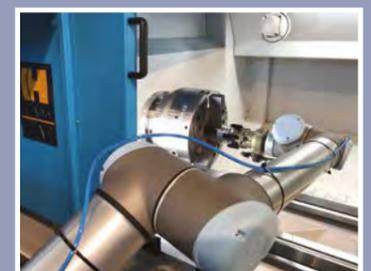
Hydraulisches Futter in Zusammenarbeit mit einem Roboter
