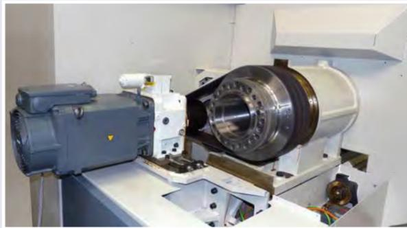
Direkter Spindeltrieb über 2-Stufen-Planetengetriebe.
