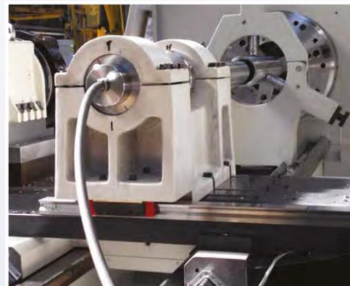
Halter auf T-Nuten montiert; für langen Bohrstangen
