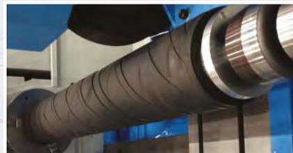
Eine mehrachsige Spezialdrehmaschine mit einem Drehdurchmesser von 2.000 mm und einer maximalen Werkstücklänge von 25 Metern. Die Maschine ist vollständig numerisch gesteuert. Der Palettentausch von Werkzeugsystemen ermöglicht Dreh-, Fräs-, Schleif- und Superfinish-Operationen. Spezielle Lünetten zum leichten Laden sehr schwerer Werkstücke.
