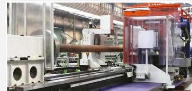
Produktionslinie zum Schleifen von Rohrschweißnähten.
