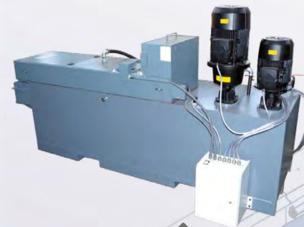
Zusätzlicher Kühlmittelbehälter mit Filter und Hochdruckpumpe
