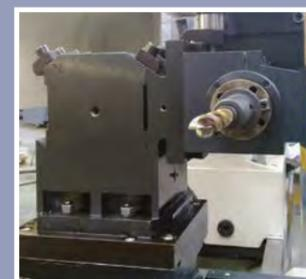
Werkzeugsystem auf dem Kreuzschlitten (T-Nuten)
