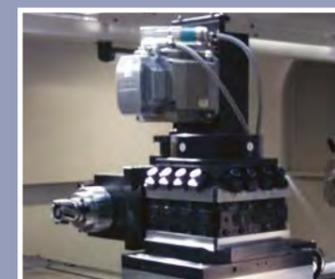
Bohr- Fräseinheit auf dem Kopfrevolver
