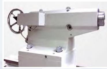
Handbetätigte Reitstockpinole in Verbindung mit Hydraulik
