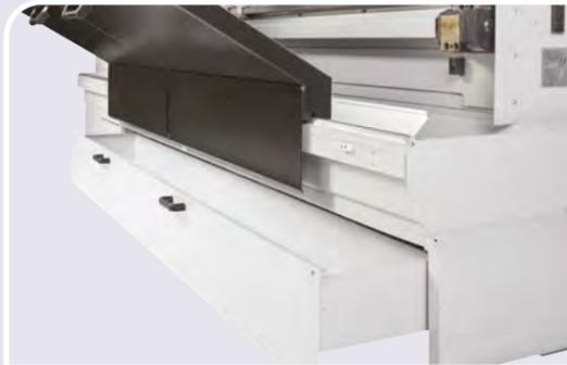
Spänewanne an der Vorderseite der Maschine
