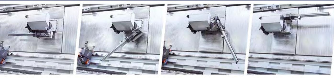
Spezieller Bohrstanthalter. Das Gerät ist für eine Bohrstanze mit einem maximalen Durchmesser von 120 mm vorbereitet. Die Bohrstanze ist in einem drehbaren Halter montiert, der es ermöglicht, die Bohrstanze ohne Demontage in die Parkposition zu bringen.
