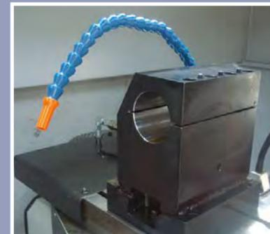
Bohrstangenhalter auf T-Nuten montiert
