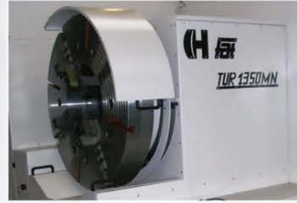
Doppelte Spindel Nase und 450mm Spindeldurchgang
