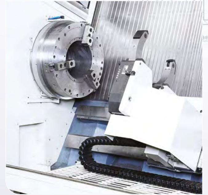
Pneumatisches Futter mit Durchgang 360mm
