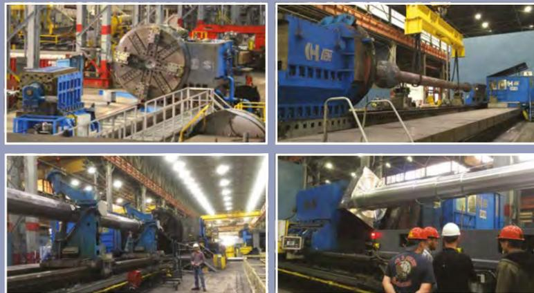
Vollautomatische Drehmaschine mit Ladestationen. Die Werkzeugmaschine ist für die Massенbearbeitung von Aluminiumbillets ausgelegt. Die Maschine besteht aus einer Drehmaschine, einem Beladesystem und einer Entladestation.
