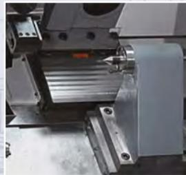
Hydraulischer Reitstock; Hub 15 mm
