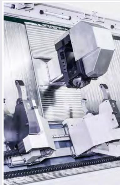
▲ Dreh-Fräskopf mit B-Achse
