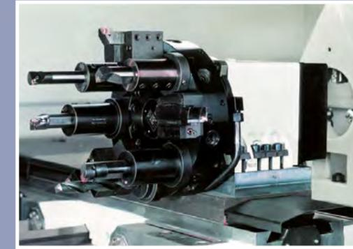
Scheibenrevolver zum Arbeiten mit feststehenden Werkzeugen
